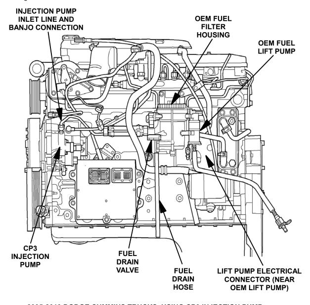
2005-2013 DODGE CUMMINS TRUCKS, USING CP3 INJECTION PUMP
